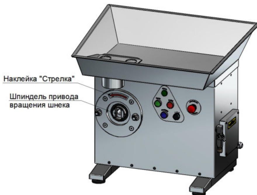
Рис. 3 Контроль направления вращения привода шнека
