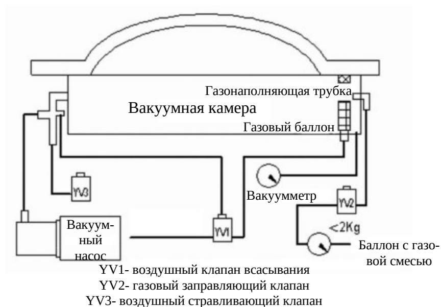
Схема вакуумного упаковщика с системой газации
