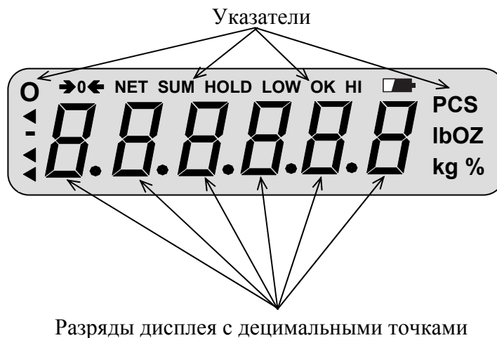
Рисунок 4.3 – Расположение указателей и разрядов дисплея
