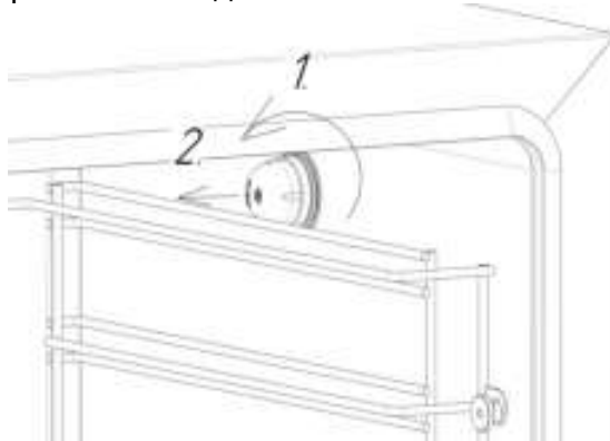
Рис. 5. Замена лампы освещения и прокладки
