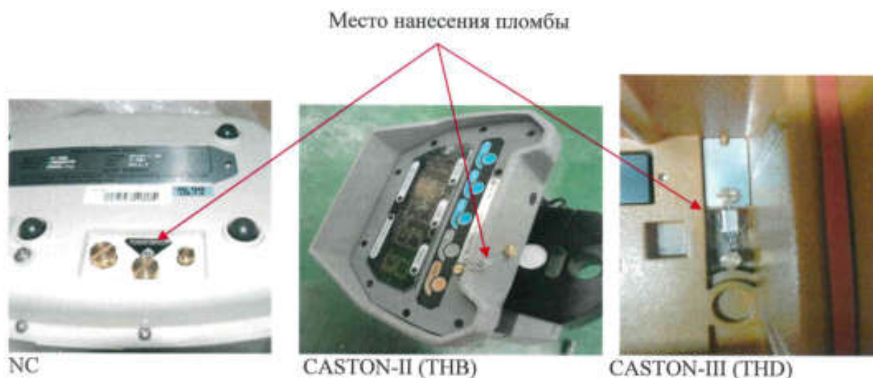
Рисунок 2 - Место пломбировки весов
