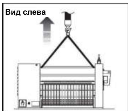
Рис.5 (Подъем машины краном)
