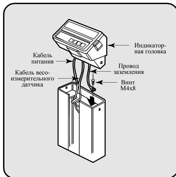
Рисунок 4.2 – Подключение заземления
