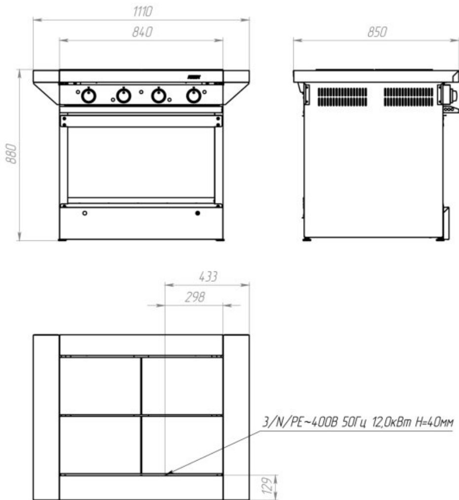
Рис.9 Габариты и схема подключений ЭПЧ-9-4-12-06.
