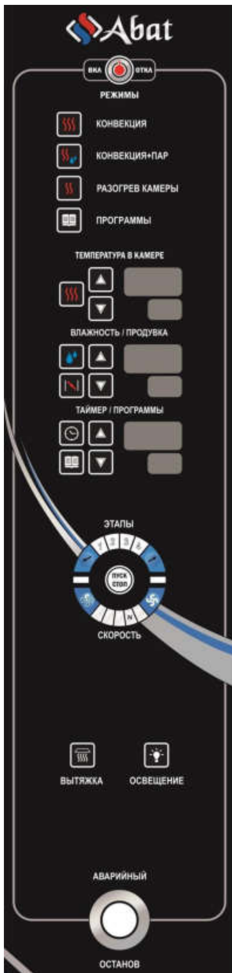
Рис. 2. Панель управления РПШ-16-2/1М и РПШ-16-2/1Л
