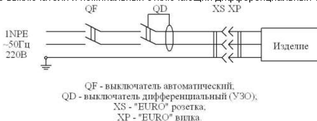
Рис. 1. Схема подключения изделия к электросети.
