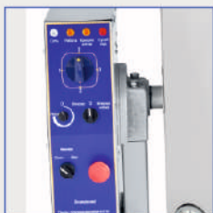
Плавная регулировка скорости вращения миксера от 0 до 120 оборотов в минуту
