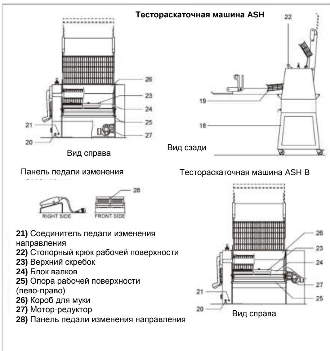
Рис. 2 (Названия основных компонентов)
