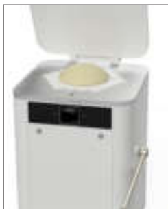
3. Поместить тесто в лоток и закрыть крышку
