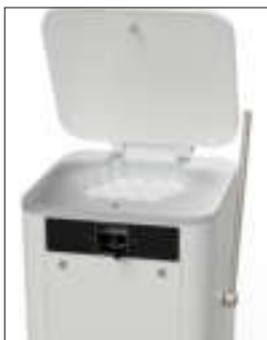
1. Поднять крышку, отцепив крюк
