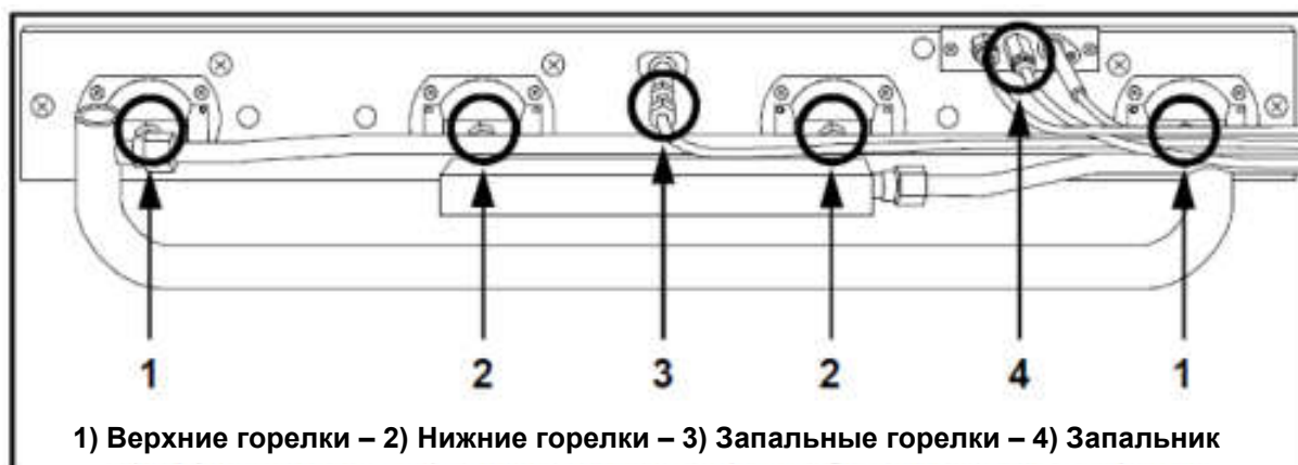
Рисунок 8 – Замена форсунок верхних, нижних и запальных горелок
