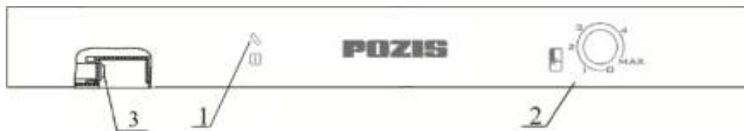
Рис. 2 Схема расположения приборов управления и сигнализации 1 – зеленая индикаторная лампа; 2 – ручка терморегулятора, 3 - выключатель освещения
