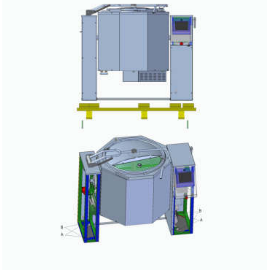
Рис. 4 Распаковка и установка котла
