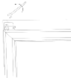
8. Draai de bovenste scharnierpen vast.
