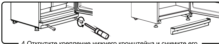
4. Открутите крепление нижнего кронштейна и снимите его.
