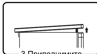
3. Приподнимите верхнюю крышку спереди и установите упор.
