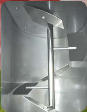
Вид изнутри. Ворошитель из нержавеющей стали
