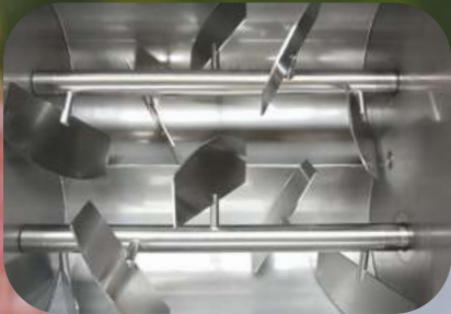
Вид изнутри. Ворошители из нержавеющей стали
