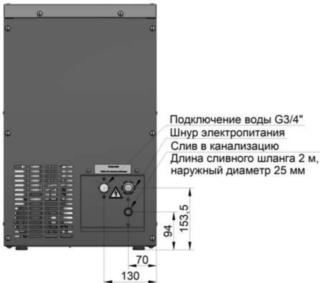
Рис. 5 Схема подключения льдогенератора
