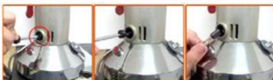
Замена угольной щетки
