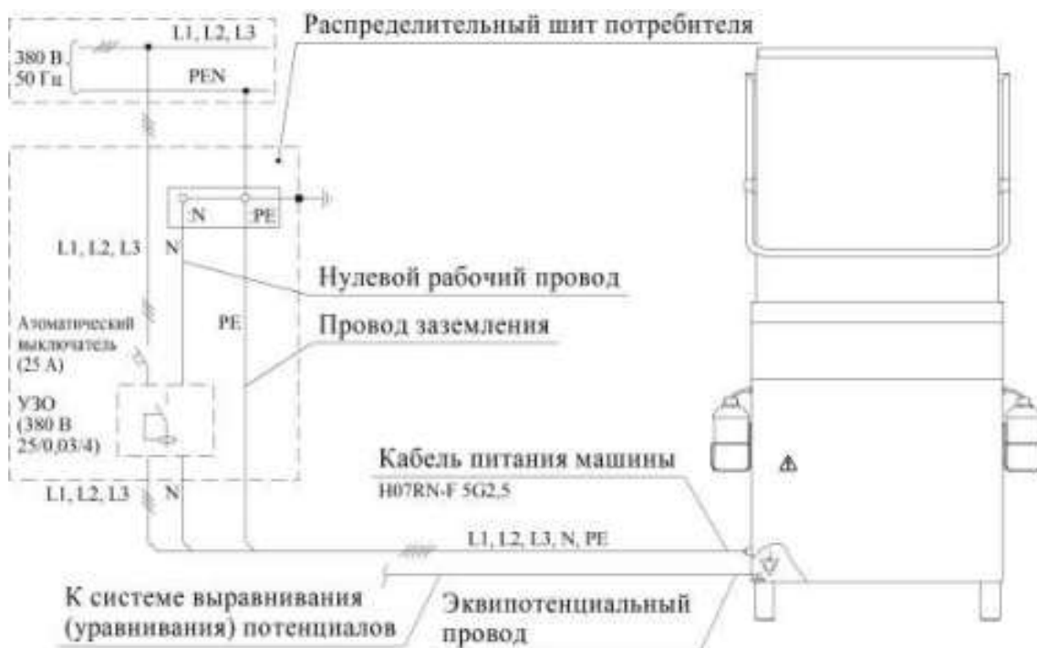
Рисунок 7 – Схема электрическая подключения машины к электрической сети
