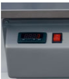
панель с микропроцессорным блоком управления
