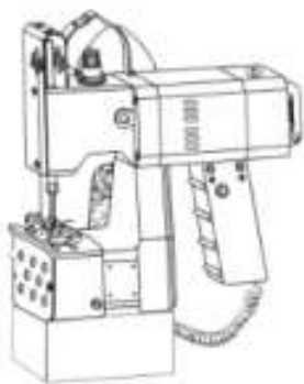
Рисунок 1: Аккумулятор устанавливается непосредственно на корпус МЗМ. Модель GK9-900A
