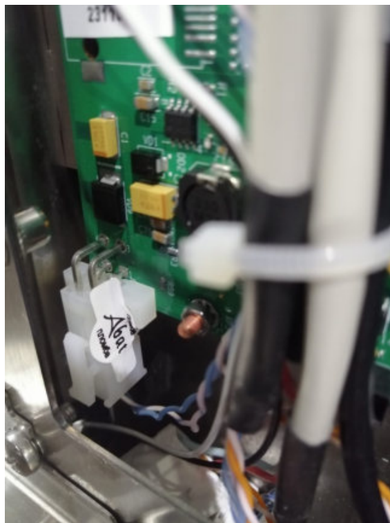
Рис. 40. Место расположения гарантийных пломб в двери печи
