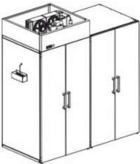
Кегератор Предназначен для кратковременного хранения и охлаждения кег на предприятиях торговли и общественного питания.
