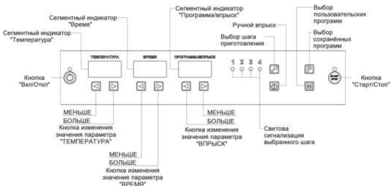
Рис. 2. Внешний вид панели управления КЭП-4П
