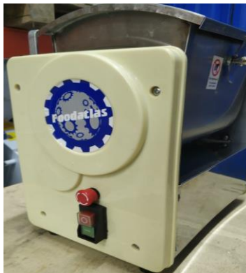
Рис 5 Панель управления. Электромагнитная комплексная кнопка Пуст/Стоп, Аварийный стоп.
