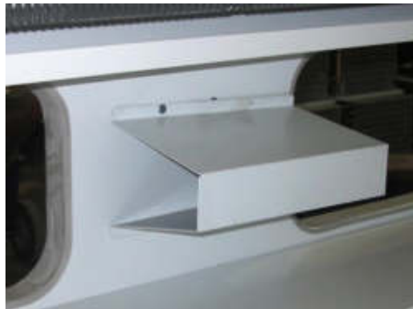
Рис. 3. Положение опоры желоба в состоянии поставки витрины
