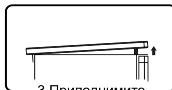
3. Приподнимите верхнюю крышку спереди и установите упор.
