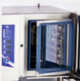
Вентилируемая дверца духовки с двойным термостойким остеклением предотвращает риск получения ожога с внешней стороны двери
