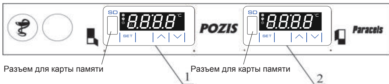
Рис.2 Схема расположения приборов управления
