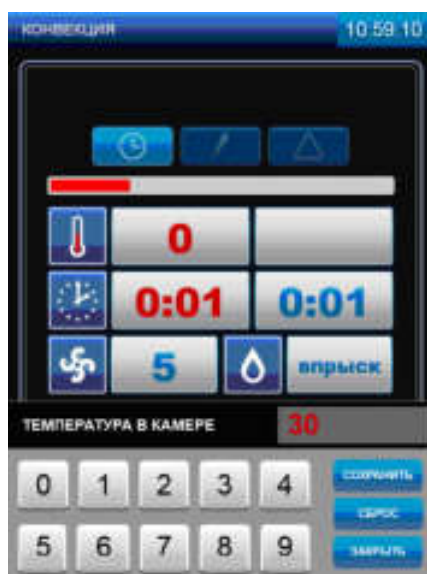
Рис.13.Редактирование параметра « ТЕМПЕРАТУРА В КАМЕРЕ »
