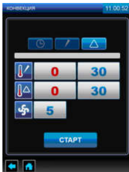
Рис.16 Режим «КОНВЕКЦИЯ» с использованием параметра «ДЕЛЬТА»
