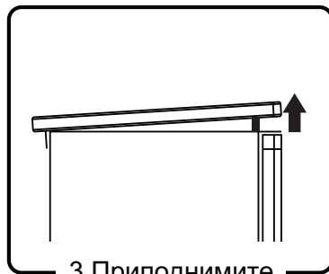
3. Приподнимите верхнюю крышку спереди и установите упор.
