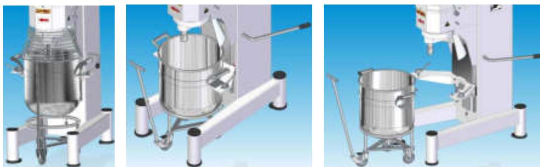
Рис. 6 Установка/извлечение дежи при помощи тележки
