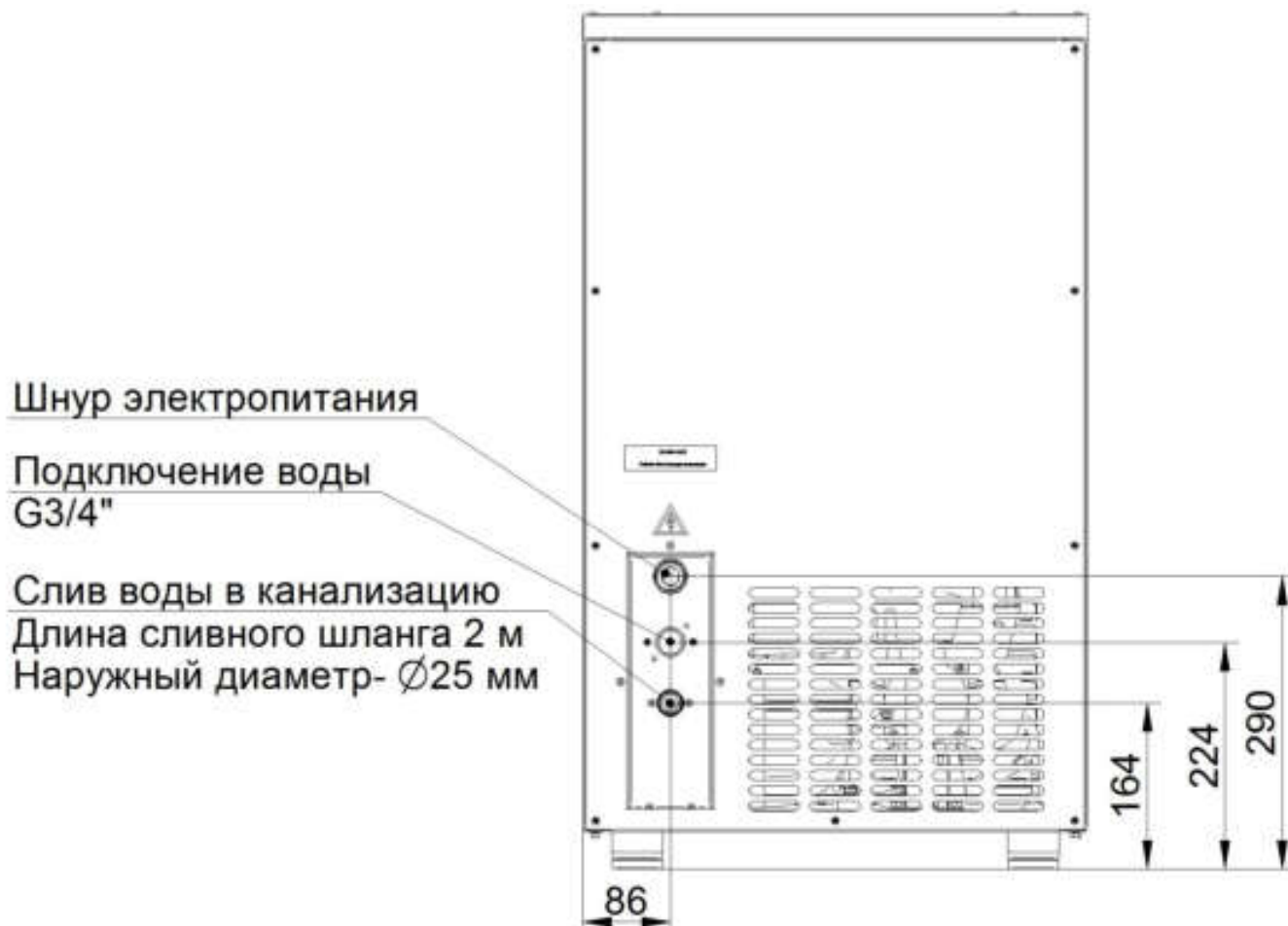
Рис. 4 Схема подключения льдогенератора
