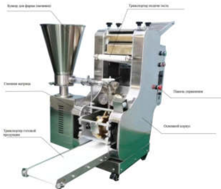
Рис1 Общий вид оборудования, основные элементы оборудования
