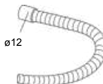
Трубка для отвода воды
