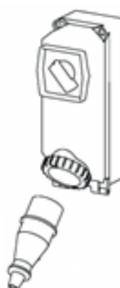
Fig. 6.2.2. - Выключатель цепи электропитания отключен
