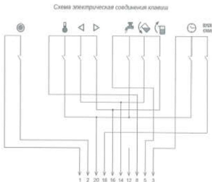
Рис. 8 Схема пленочной клавиатуры
