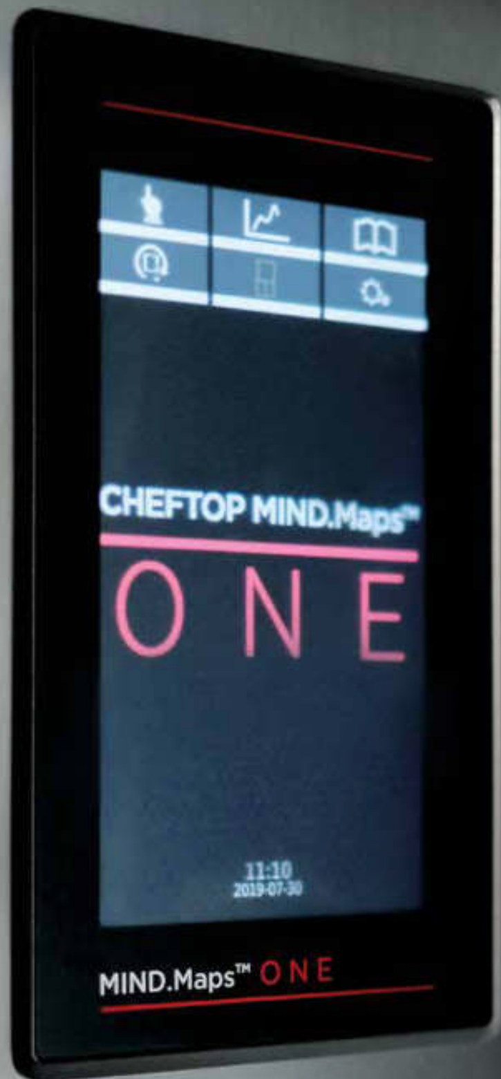
Резистивная панель управления ONE
